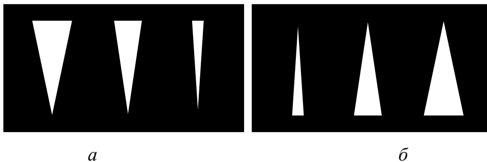
Рис. 2. Дифракція на клиноподібній щілині обумовлює розширення дифракційного максимуму на вістрі клина і звуження – на його основі:
