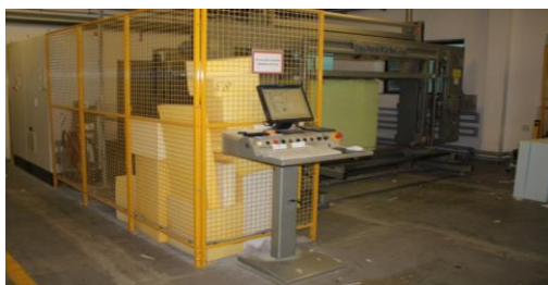
Rys. 10.7. Maszyna FeckenKirfel służąca do rozkroju pianki poliuretanowej w blokach typu T-25
