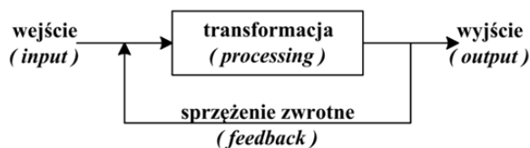
Rys. 21.2. Współpracujące elementy systemu
