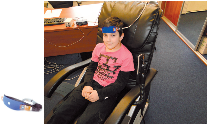
Fot. 14. Wygląd zewnętrzny opaski hemoencefalografu i sposób umieszczenia jej na głowie osoby badanej
